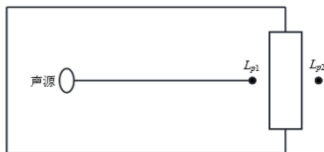
图 4-1 室内声源等效为室外声源图例
