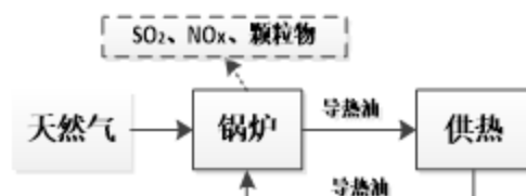
图 2-1 锅炉运行流程及产污节点示意图
